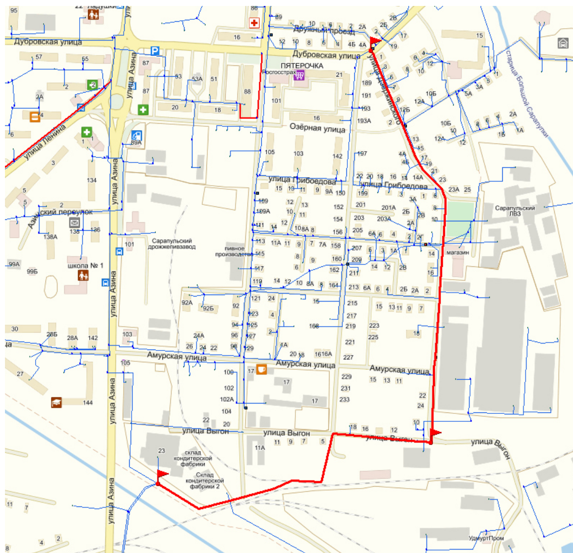
Рисунок 34 – Путь построения пьезометрического графика (от ПГ-274 до ВК-4-105-15)
