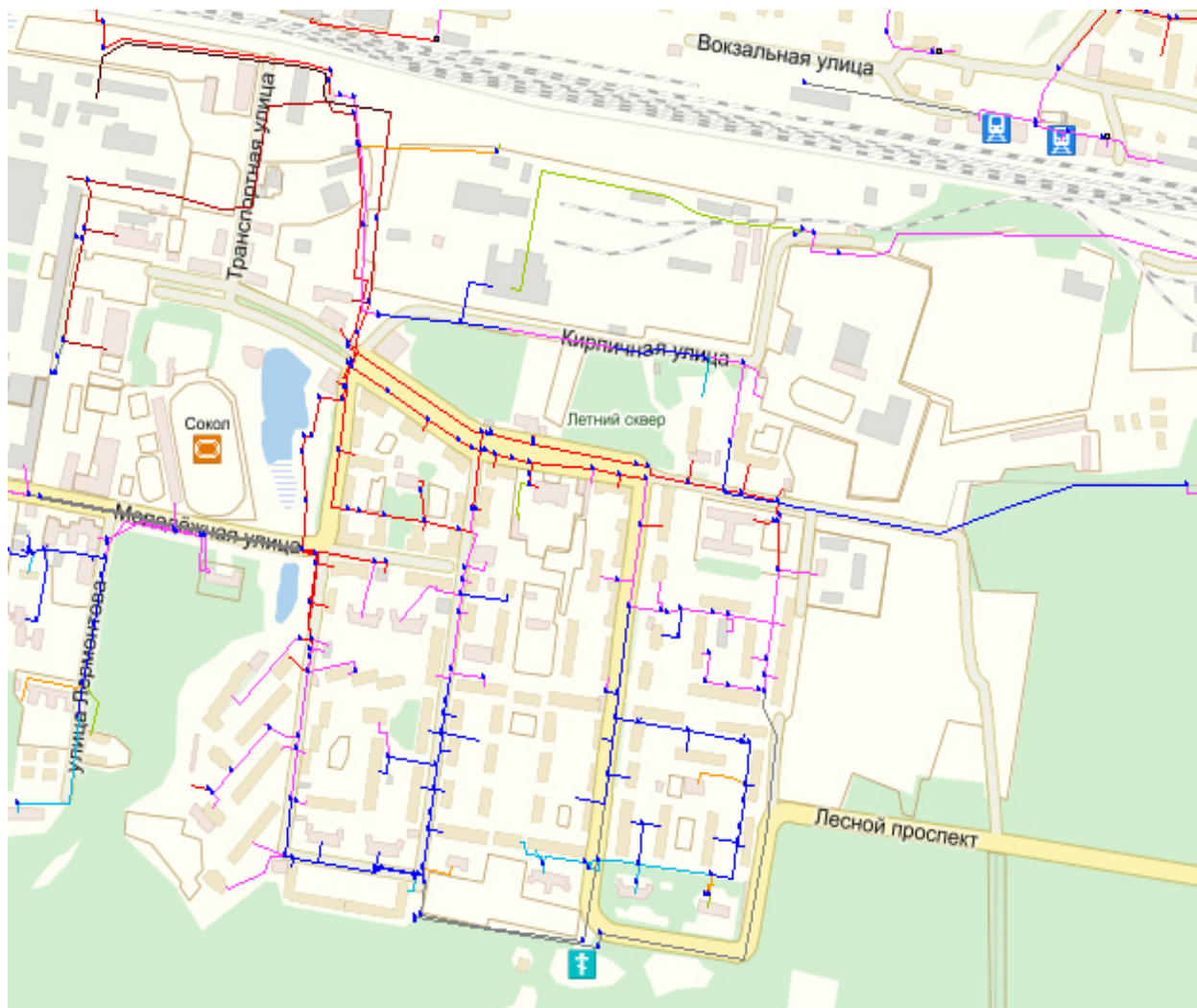
Рисунок 75 – Распределение давления в магистральных и квартальных участках водопроводной сети зоны водоснабжения ВНС-Южный г. Сарапула
